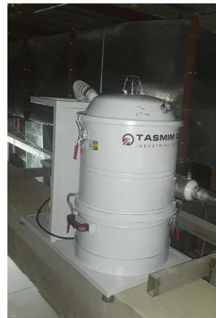
این دستگاه دائم کار برای استفاده در محیط هایی است که از نظر فضایی، امکان نصب جاروبرقی صنعتی وجود ندارد. این غبار گیر با صدای بسیار کم، مخزن ۵۰ لیتری و همچنین یک عدد فیلتر کیسه ای پلی استر، توانایی جمع آوری غبار حاصل از بسیاری از دستگاه ها و ماشین آلات تولیدی را درون خود دارد.
