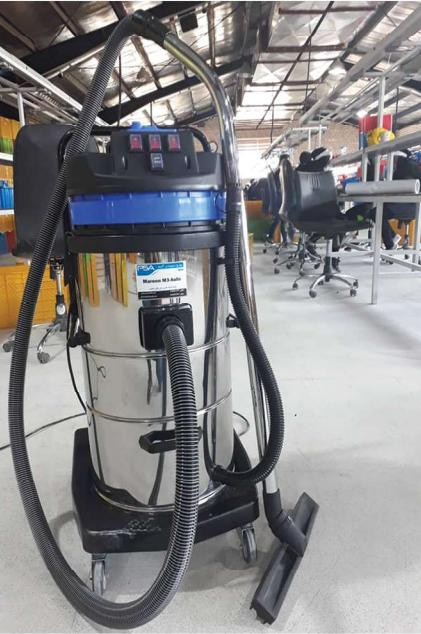
جاروبرقی صنعتی آب و خاک سه موتوره سری Maroon، مناسب جهت جمع آوری انواع مواد خشک و تر می باشد. سیستم تعویض موتور اتوماتیک نصب شده بر روی این دستگاه، باعث می شود، موتورها در زمانهای کوتاه و معین تعویض شده و فشاری به دستگاه وارد نشود.
