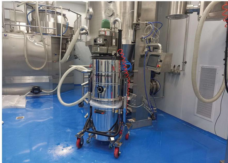
این جاروبرقی صنعتی مجهز به توربین دائم کار می باشد که برای کار نظافتی و تمیزکاری صنعتی ایده آل است. محفظه فیلتر حاوی یک فیلتر پلی استر با سطح بزرگ است که دارای گواهینامه کلاس M می باشد و برای کار با ریزترین گرد و غبارها ایده آل است.
