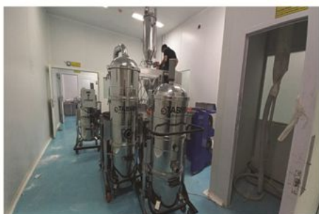
اتصال به ماشین آلات داروسازی در اتاق تمیز
