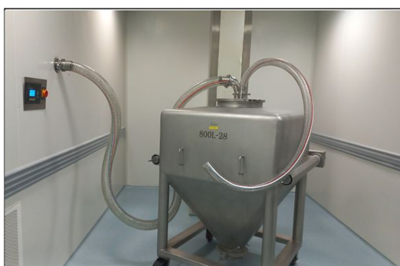
انتقال پودر به بین بلندر
